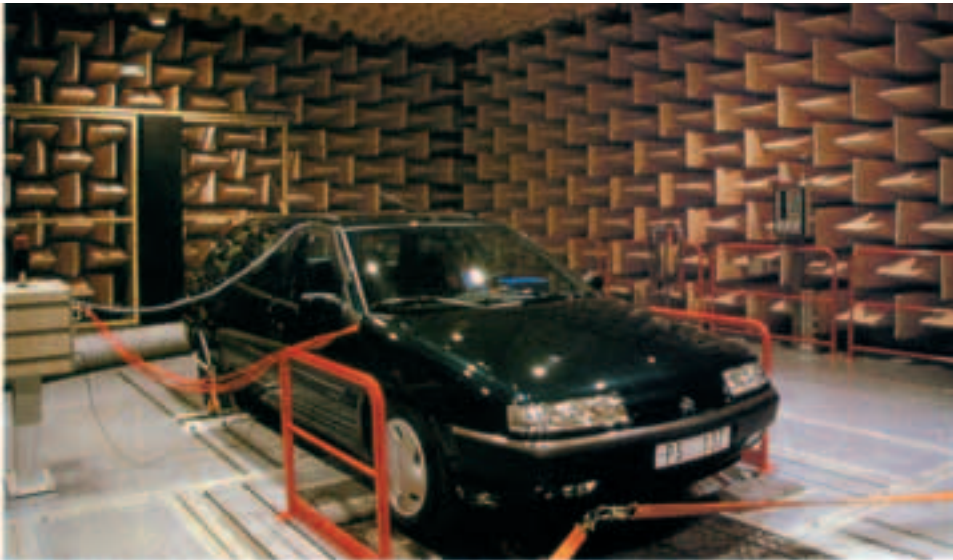
VIBRACIONES. En salas especiales se someten a los vehículos a multitud de pruebas para comprobar que no hay un ruido de más.
